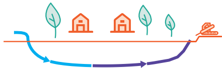
3 Tirage du câble à haute tension
