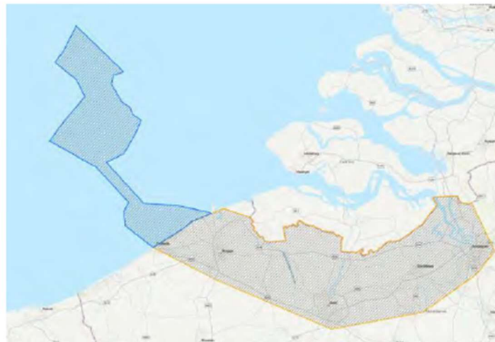
Figuur 6-3 Zoekzones voor de kabels voor de nieuwe hybride HVDC interconnectie België-Denemarken
