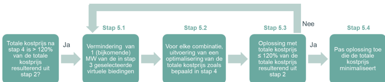
Figuur 6 – proces in de situatie waarin de totale kostprijs van de aFRR-capaciteitsveiling na stap 4 hoger zijn dan 120% van de totale kostprijs resulterend uit stap 2 (in de veronderstelling dat de TDC Factor 120% is)
