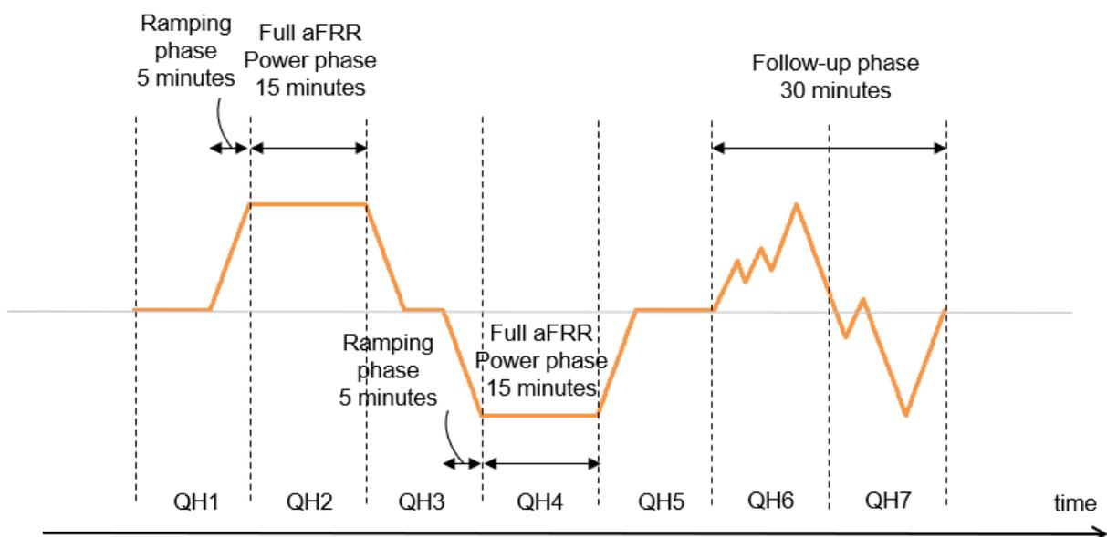
Figure 2 – Test de préqualification concernant les deux directions
