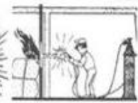
Fig. 2: Ontbrekking door contact met ontvlambare vloeistof.
