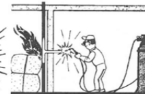
Fig. 2. Inflammation au contact de conduites invisibles chauffées.
