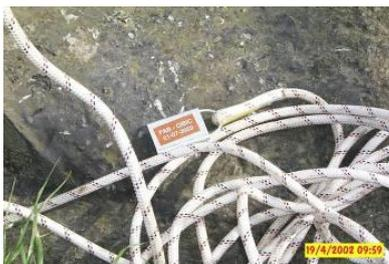
s'attache à cette ligne de vie à l'aide d'un stop chute (coulisseau sur cordage) fixé à l'attache sternale du harnais via une longe avec amortisseur.
