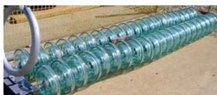
Il faut d'autant plus d'isolateurs que la tension électrique appliquée au conducteur de la ligne est élevée.
