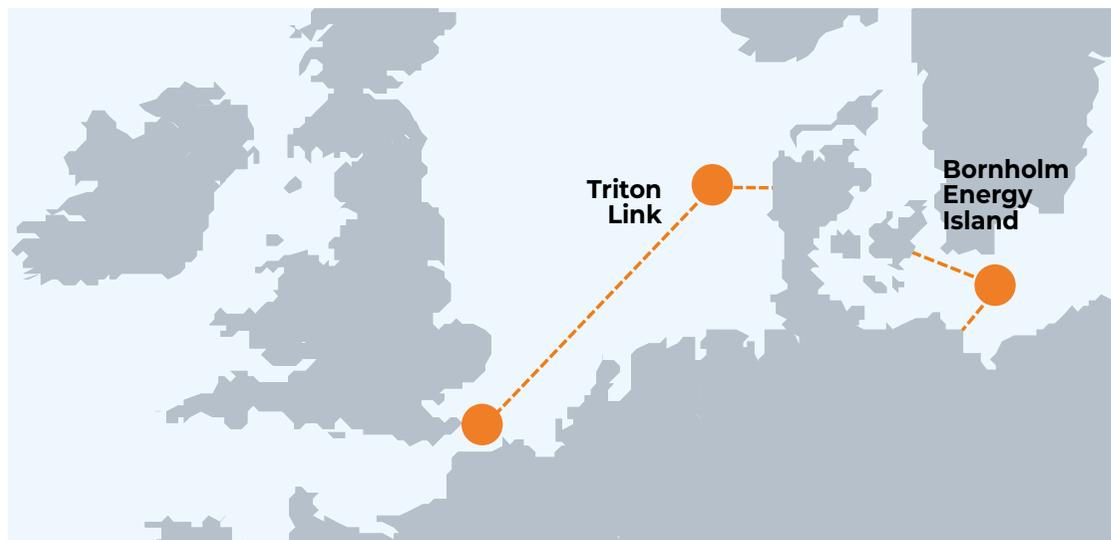
50Hertz a également signé un accord de coopération avec Energinet en vue de préparer la construction d'une deuxième interconnexion hybride en mer Baltique : le projet Bornholm Energy Island. Lors de la première phase du projet, une interconnexion HVDC sera construite entre les deux pays, sur une distance totale de 400 km. Depuis l'île de Bornholm, le câble sous-marin partira vers l'ouest en direction de
