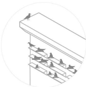
1. Stormmuur met richels t.b.v. klifbroeders
